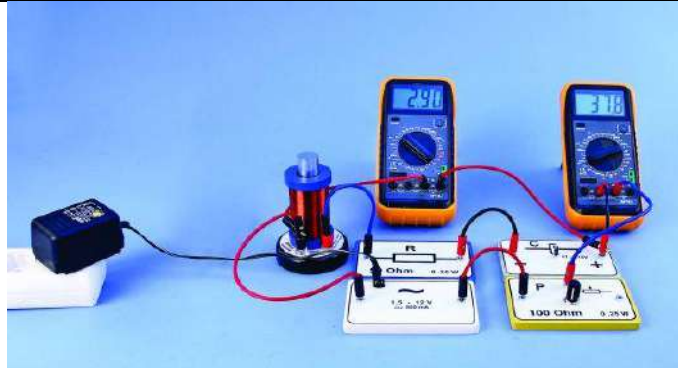
Circuit RLC serie, în curent alternativ
