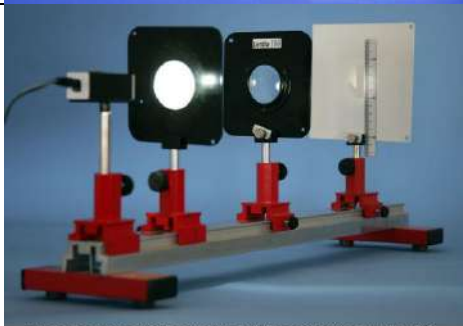
Imaginea unui obiect asimetric dată de o lentilă convergentă, determinarea distanței focale a lentilei
