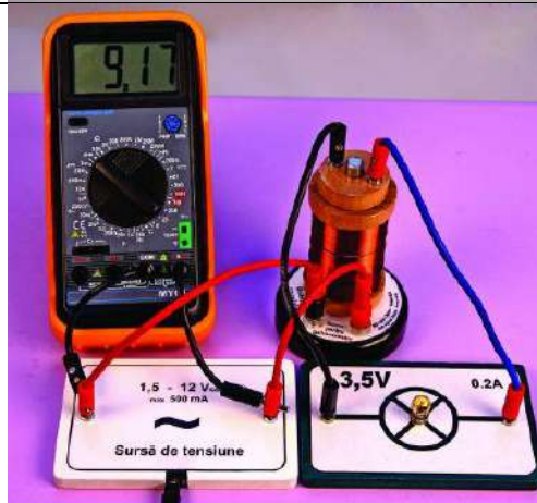
Transformator, coborâtor de tensiune
